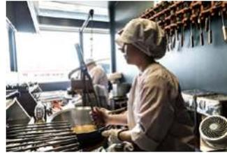
ツヤ付けをした焼き型に、そっと生地を流し込み、そっと閉め、焼き台に乗せる。乱暴な金属音が一切しない、丁寧な手焼きの工程。
